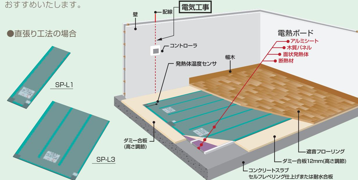
施工床を選ばない電熱ボードは、コンクリートへの直貼り工法、二重床工法にも対応。パネル間の連結は、はめ込むだけのコネクタ方式で、施工時間も大幅に短縮されます。さらに、断熱材を組み入れた木質パネルと一体構造で、従来の電気式床暖房と比較して、電気代を約20~30%コストダウンできます。
